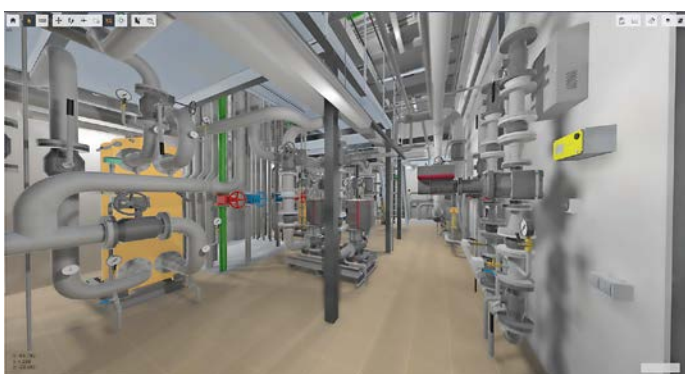
Abbildung 2; Digitaler Zwilling. Quelle: Siemens Schweiz, 2023, www.siemens.com/ch
